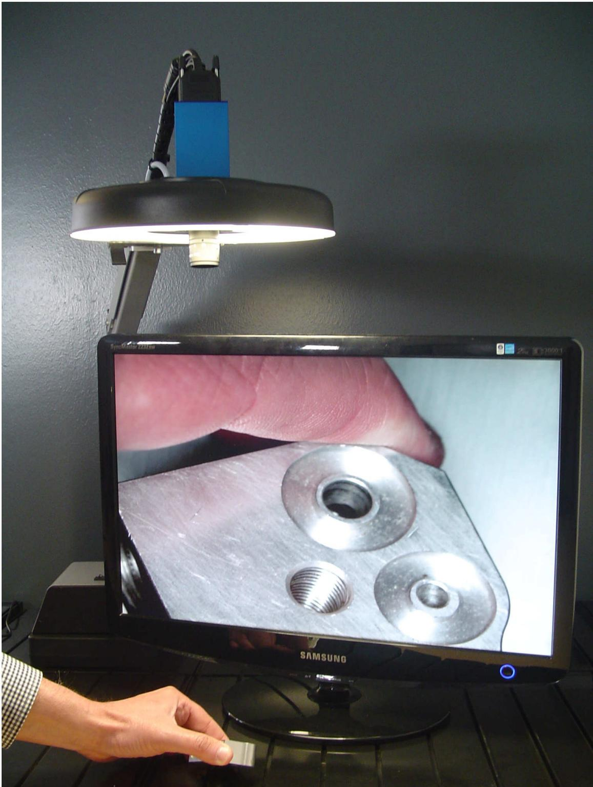
**Elektronische Lupenleuchte mit integrierter, hochwertiger 3 Megapixel-Farbkamera mit direkter Anschlussmöglichkeit eines digitalen Monitors über die DVI-Schnittstelle. Sie vereint die Einfachheit der Bedienung früherer analoger Videokameras mit der hohen Bildqualität und den modernsten Bildverbesserungsmöglichkeiten einer Digitalkamera.**
