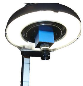
**Aufgrund einer sehr geringen Verzögerungszeit (Latenz) zwischen Bildaufnahme und Bilddarstellung am Monitor ist auch ein direktes Manipulieren des Beobachtungsobjektes ohne die sonst üblichen störenden Verzögerungen möglich.**
